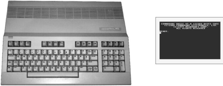
Abb. 1: Den Commodore 128 gab es auch in einer PC-Anmutung. Ich hatte diese Version, wo der Rechner direkt in die Tastatur eingebaut und nicht in ein separates Gehäuse ausgelagert ist. Das Diskettenlaufwerk wurde als separates Gerät angeschlossen. Als ↑ „Betriebssystem“ gibt es nur eine Programmiersprache namens Basic mittels derer man Disketteninhalte anzeigen lassen, Programme starten oder auch programmieren konnte. [Abbildungen: Wikipedia]
